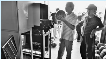
▲すいかを機械に通し、内部を判定
